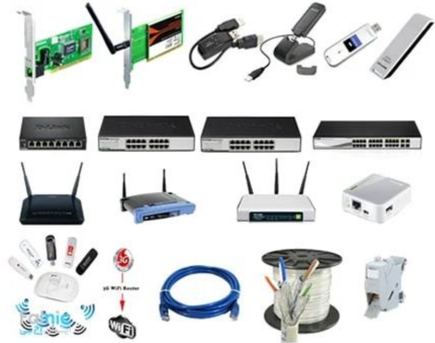
برخی از تجهیزات اکتیو و پسیو در شبکه
